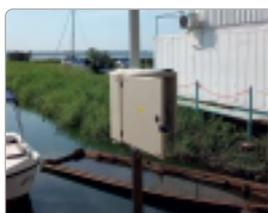
Estación Posadas con panel solar para la recarga de batería de 12V y modem de comunicación celular. Cuenta con un sensor tipo radar.
