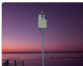
Estación Itatí con panel solar para la recarga de batería de 12V y modem de comunicación celular. Cuenta con un sensor tipo radar.
