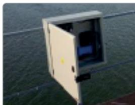
Estación Ituzaingó con panel solar para la recarga de batería de 12V y modem de comunicación celular. Cuenta con un sensor tipo radar.
